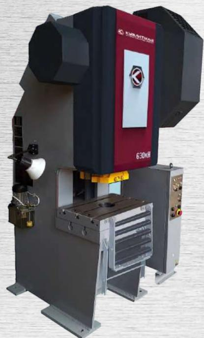
Прессы однокривошипные простого действия открытые с неподвижным столом ненаклоняемые предназначены для различных операций холодной штамповки: вырубки, пробивки отверстий, гибки, неглубокой вытяжки, просечки и т.д. Прессы могут применяться как самостоятельно, так и в составе автоматизированных комплексов и линий.
