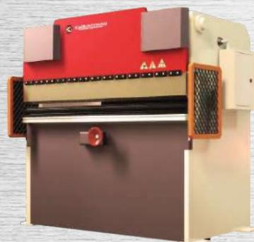
Прессы предназначены для изготовления деталей из листового и полосового проката методом холодной гибки.
