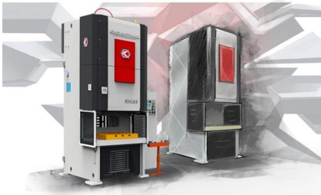
Прессы кривошипно-коленные чеканочные усилием до 25 МН (2500 тс) и кривошипно-коленные для холодного выдавливания металла усилием до 6,3 МН (630 тс)
